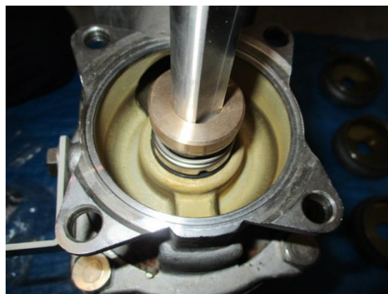
メカニカルシール交換後
