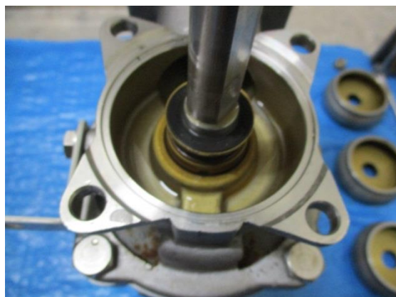
メカニカルシール交換前
